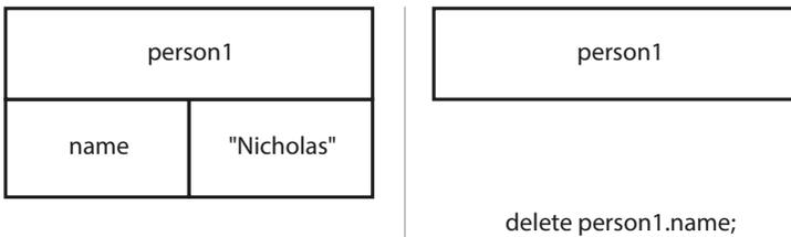
**Abb. 4–2** Wenn Sie die Eigenschaft `name` mit `delete` löschen, wird sie komplett von `person1` entfernt.
